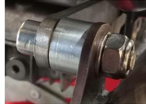
11. Die Auspuffanlage ausrichten und alle Schraubverbindungen, vom Auslass beginnend, nach hinten festziehen
